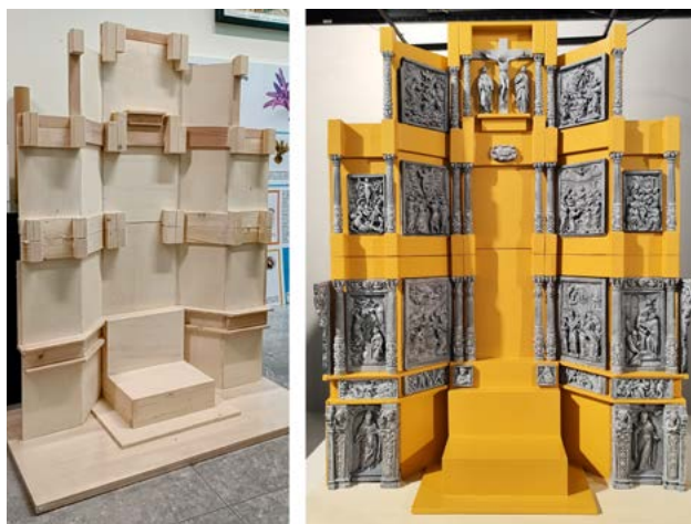
Figura 4. Fotografies de la maqueta 3D, que combina una estructura de fusta amb impressions 3D. A l'esquerra, l'estructura de fusta (fotografia de Marco Callieri). A la dreta, el resultat final, amb els relleus impresos col·locats al lloc corresponent.
